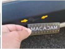
Joint de coffre/hayon, Déchirure, E - Remplacer
