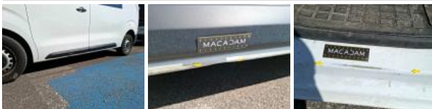
Panneau ARG, Mauvaise réparation, LI - Réparer et peindre (complet)
