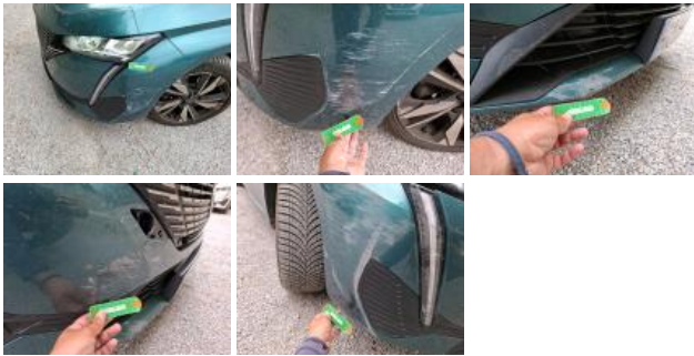
Grille de pare-chocs AV M, Griffe(s), E - Remplacer
