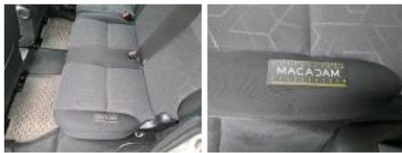
Revêtement assise ARG, Déchirure, Réparer/remplacer (montant forfaitaire)
