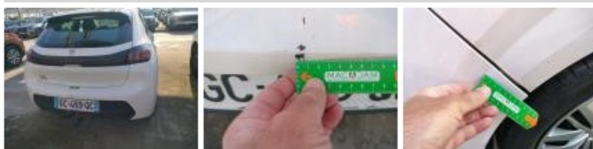
Joint de coffre/hayon, Déchirure, E - Remplacer
