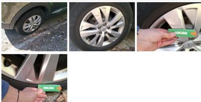
Jante alum. AVD, Griffe(s), Réparer/rempl. (montant forfaitaire)
