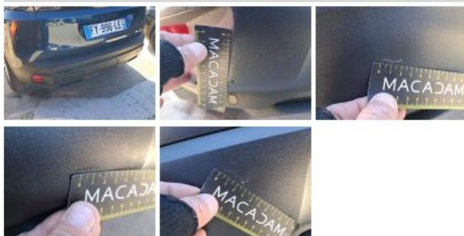
Pare-chocs AR, Griffe(s), E - Remplacer
