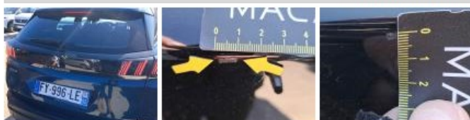
Pare-chocs AR, Griffe(s), E - Remplacer
