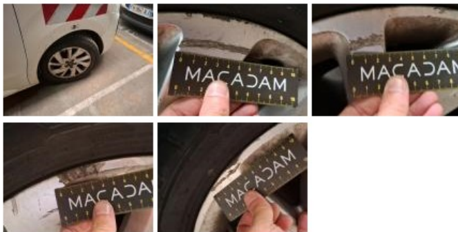
Protect. pass. roue AVD, Déformé / Forcé, E - Remplacer
