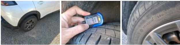
Pneu AVD, Hors tolérance, E - Remplacer
