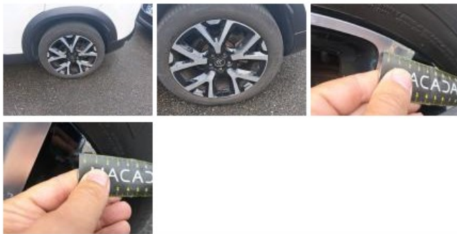
Pneu ARD, Hors tolérance, E - Remplacer
