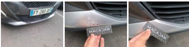
Spoiler AV, Griffe(s), Réparer/rempl. (montant forfaitaire)
