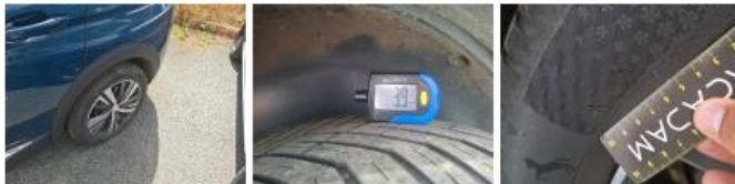
Pneu ARD, Hors tolérance, E - Remplacer
