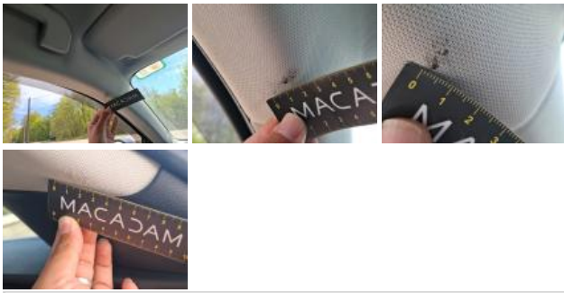
Garnit. montant AVG, Griffe(s), Réparer/rempl. (montant forfaitaire)
