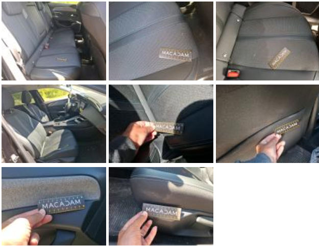
Revêtement assise siège AVD, Brûlé, E - Remplacer
