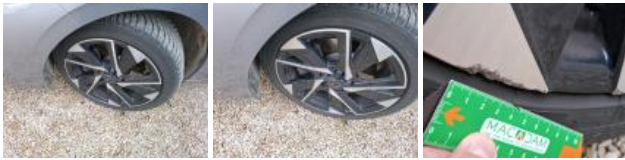
Pneu ARG, Déchirure, E - Remplacer
