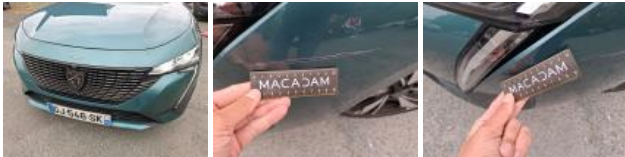
Feu de jour AVG, Griffe(s), E - Remplacer
