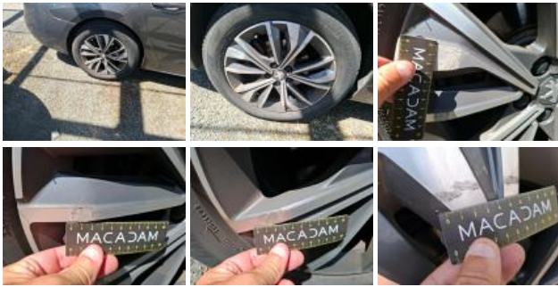
Pneu ARD, Déchirure, E - Remplacer
