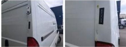
Carrosseriehoek achter rechts, Deuk(en) en kras(sen), LI - Herstellen en schilderen (compleet)
