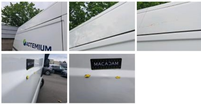
Carrosseriehoek achter rechts, Deuk(en) en kras(sen), LI - Herstellen en schilderen (compleet)
