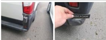
Kofferdeur L, Deuk(en) en kras(sen), LI - Herstellen en schilderen (compleet)
