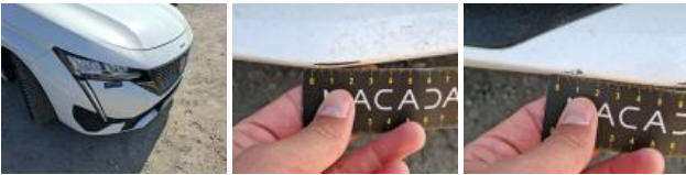
Porte ARD, Bosse(s), LI - Réparer et peindre (complet)
