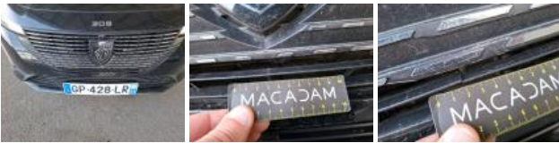
Grille de pare-chocs AV M, Cassé, E - Remplacer
