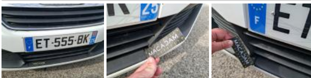
Grille de pare-chocs AV M, Dégrafé, Dépose/Repose
