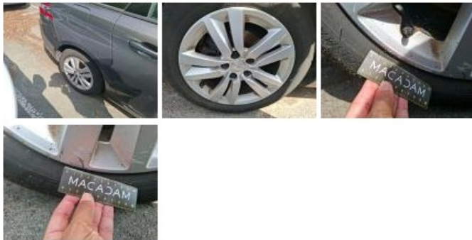
Jante alum. AVG, Griffe(s), E - Remplacer
