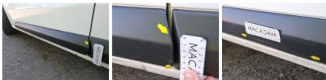
Bas de caisse ext G, Bosse(s), Le - Remplacer et peindre
