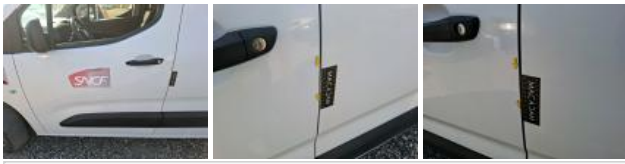
Moulure porte AVG, Griffe(s), Réparer/rempl. (montant forfaitaire)
