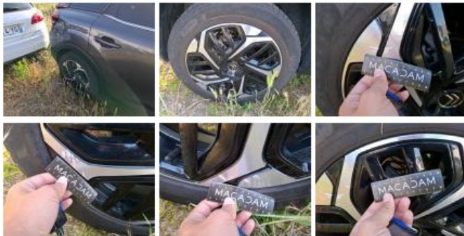
Pneu ARG, Hors tolérance, E - Remplacer
