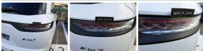
Feu ARD, Infiltration d'eau, E - Remplacer
