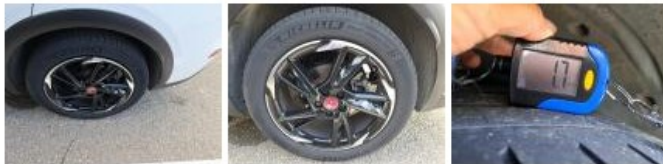
Pneu ARD, Hors tolérance, E - Remplacer
