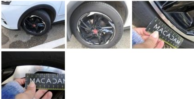
Pneu ARG, Hors tolérance, E - Remplacer
