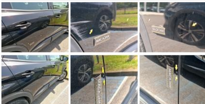
Moulure d'aile ARD, Griffe(s), E - Remplacer
