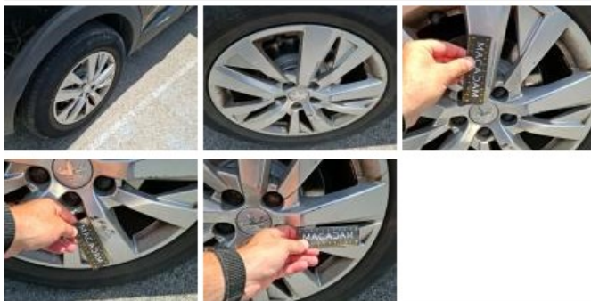
Pneu AVD, Hors tolérance, E - Remplacer
