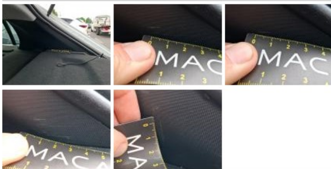
Joint de coffre/hayon, Déchirure, E - Remplacer
