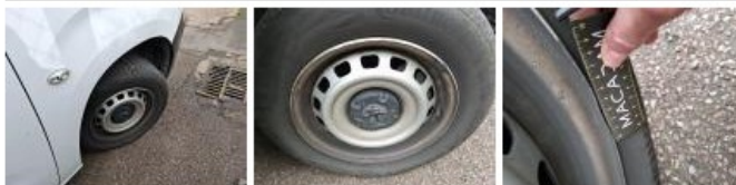
Jante tôle AVD, Déformé / Forcé, Acceptable
