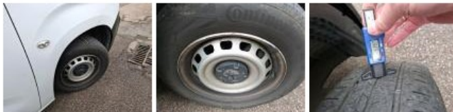
Jante tôle AVD, Déformé / Forcé, Acceptable
