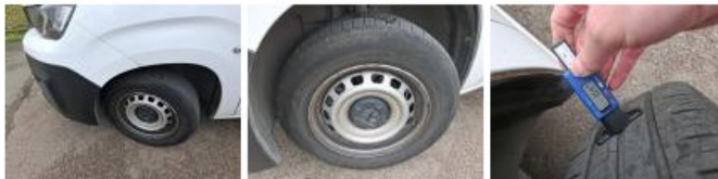
Pneu AVD, Hors tolérance, E - Remplacer
