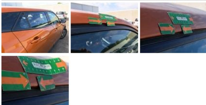
Jt ext lèche-vitre ARD, Dégrafé, Dépose/Répose
