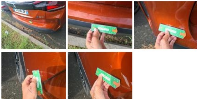
Pare-chocs AR, Griffe(s), E - Remplacer
