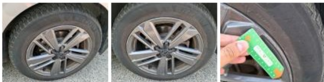
Jante alum. ARD, Griffe(s), Réparer/rempl. (montant forfaitaire)
