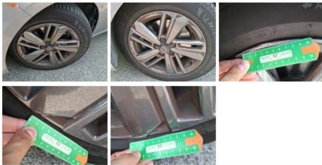
Jante alum. ARG, Griffe(s), Réparer/rempl. (montant forfaitaire)
