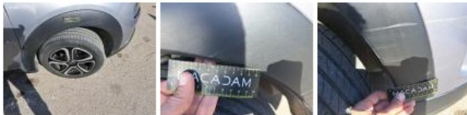
Moulure d'aile AVD, Griffe(s), Acceptable
