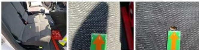
Revêtement assise siège AVD, Brûlé, E - Remplacer
