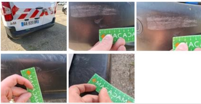
Porte de malle AR D, Bosse(s) et griffe(s), Acceptable
