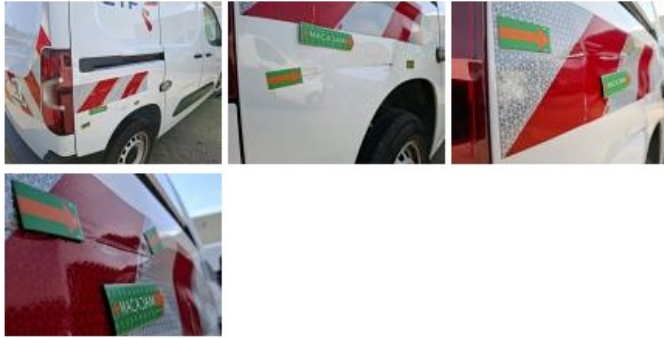
Porte coulissante D, Bosse(s), LI - Réparer et peindre (complet)
