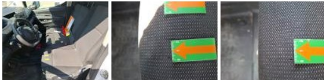
Revêtement assise siège AVD, Brûlé, E - Remplacer
