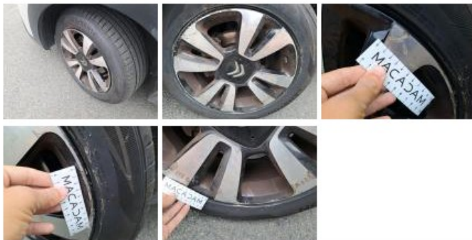
Pneu ARG, Hors tolérance, E - Remplacer
