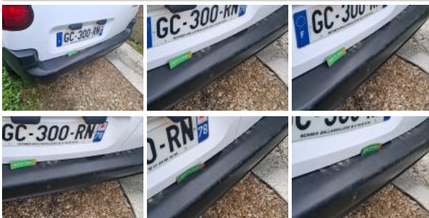
Pare-chocs AR, Déformé / Forcé, E - Remplacer
