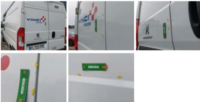
Porte de malle AR D, Bosse(s) et griffe(s), LI - Réparer et peindre (complet)
