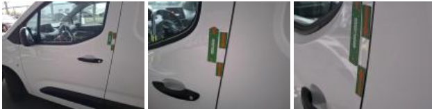
Bas de caisse ext G, Bosse(s), LI - Réparer et peindre (complet)
