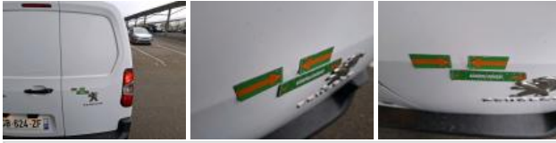
Pare-chocs AR, Griffes(s), LI - Réparer et peindre (complet)
