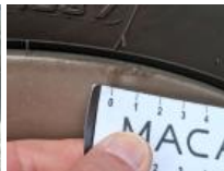
Aile ARG, Bosse(s), LI - Réparer et peindre (complet)
