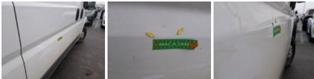
Panneau Latéral D, Bosse(s), LI - Réparer et peindre (complet)
