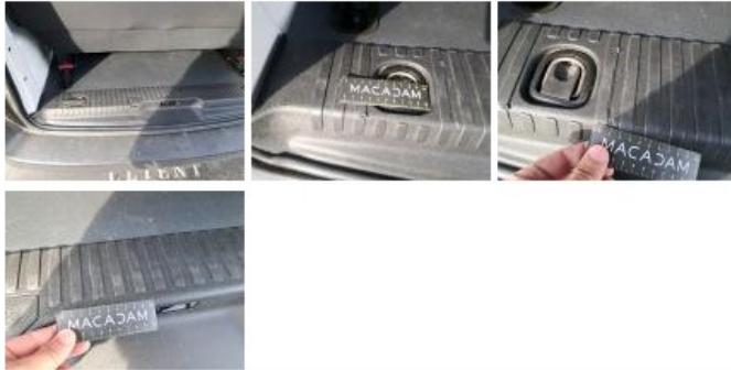
Pare-chocs AR, Déformé / Forcé, E - Remplacer
