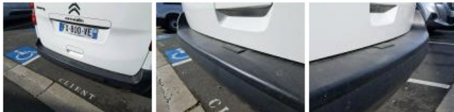
Pare-chocs AR, Déformé / Forcé, E - Remplacer
