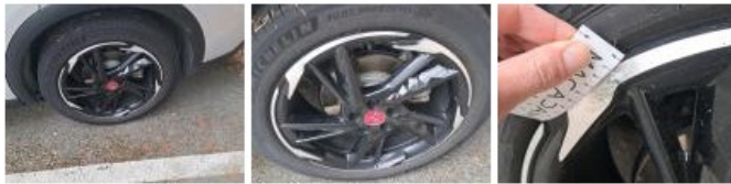
Pneu ARG, Hors tolérance, E - Remplacer
