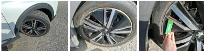
Pneu ARD, Déchirure, E - Remplacer
