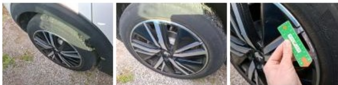
Pneu ARG, Déchirure, E - Remplacer
