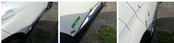
Moulure porte ARD, Déformé / Forcé, E - Remplacer
