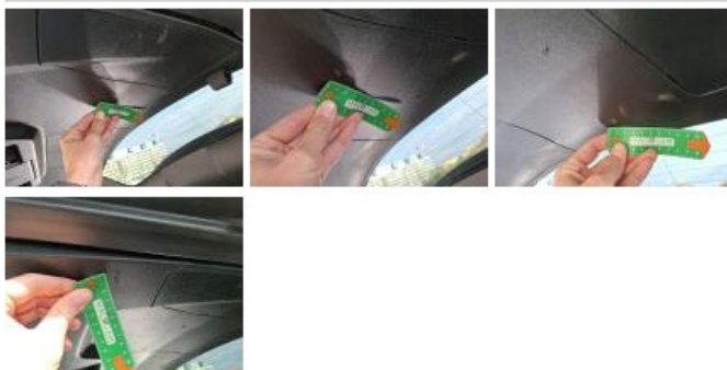
Pare-chocs AR, Griffé(s), E - Remplacer
