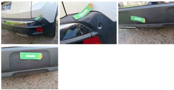
Moulure de pare-chocs AR, Fêlure, E - Remplacer
