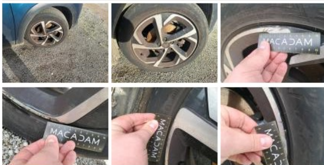
Pneu AVG, Hors tolérance, E - Remplacer
