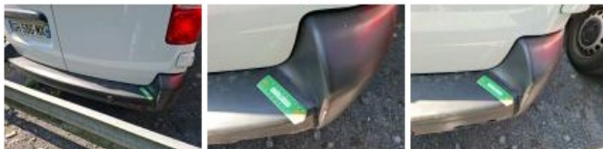
Obturbateur /Cache AR, Dégrafé, Dépose/Répose
