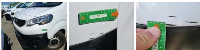
Pare-chocs AV, Fêlure, E - Remplacer
