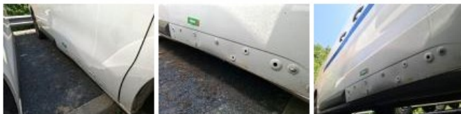
Bas de caisse ext D, Bosse(s), Le - Remplacer et peindre
