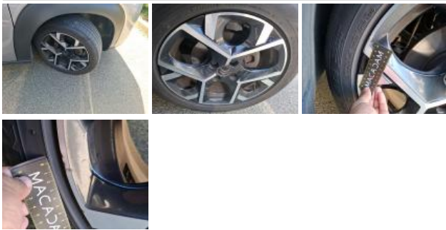
Jante alum. ARD bi-ton/polychrome, Dégâts chimiques, Réparer/rempl. (montant forfaitaire)
