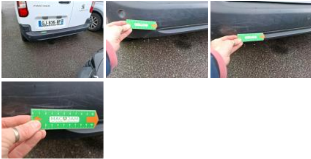
Porte de malle AR G, Bosse(s) et griffe(s), Acceptable
