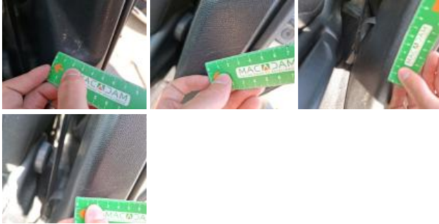
Joint de porte AVG, Dégrafé, Dépose/Répose
