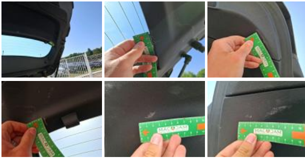
Joint de coffre/hayon, Déchirure, E - Remplacer
