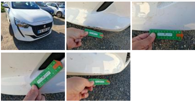
Moulure de pare-chocs AV, Dégrafé, Dépose/Repose
