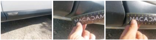
Bas de caisse ext G, Bosse(s) et griffe(s), Le - Remplacer et peindre
