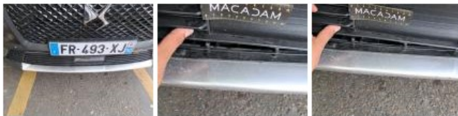
Moulure de pare-chocs AVG, Dégrafé, Dépose/Répose
