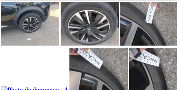
Pneu ARD, Déchirure, E - Remplacer
