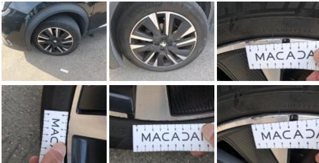
Pneu ARG, Déchirure, E - Remplacer
